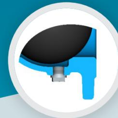
Bei normaler Durchflussrichtung im Rohr wird die Kugel automatisch weggedrückt, sodass der Rohrinhalt ungehindert durch das Gehäuse der Armatur fließen kann. Bei entgegengesetzter Durchflussrichtung rollt die Kugel in die geschlossene Position zurück, sodass das Rohr abgedichtet und kein Rückfluss der im Rohr befindlichen Flüssigkeit möglich ist.
