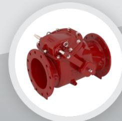
Bei normaler Durchflussrichtung im Rohr wird die Klappe in die geöffnete Position gedrückt, sodass der Rohrinhalt ungehindert, d.h. zu 100 %, durch die Rückschlagklappe fließen kann. Bei entgegengesetzter Durchflussrichtung geht die Klappe automatisch in die geschlossene Position zurück, sodass kein Rückfluss der im Rohr befindlichen Flüssigkeit möglich ist.
